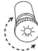
**Fernlichtkontrolle:** Der Blinkerhebel auf der linken Seite der Lenksäule kontrolliert das Fernlicht. Drücken sie den Hebel nach vorn, so schaltet sich das Fernlicht ein. Ziehen Sie ihn zu sich, so schaltet sich das Fernlicht wieder aus.
