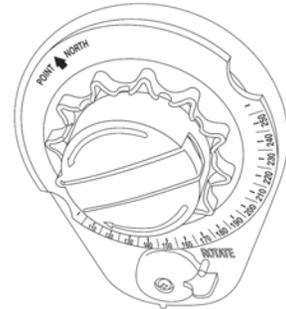
**Bewegen Sie das Fahrzeug niemals bei ausgefahrener Antenne.** Um die Antenne einzufahren, ziehen Sie den Ring herunter und drehen Sie ihn, bis beide Pfeile in derselben Richtung zeigen. Dann können Sie die Kurbel drehen, bis Sie hören, dass die Antenne das Dach berührt. Wenn Sie sich nicht sicher sind, dass die Antenne korrekt heruntergefahren ist, können Sie vorsichtig die Leiter hinaufklettern und auf dem Dach nachsehen.
